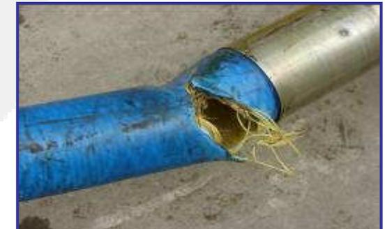
SE ALCANZA PRESIÓN DE RUPTURA DE LA TUBERÍA A 154 KG / CM<sup>2</sup> Y 45° C.
