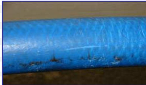
SE ALCANZA PRESION DE 105 KG/CM<sup>2</sup>, SE OBSERVA **MARCA** DE LA **MALLA INTERNA** Y **REDUCCIÓN** DEL **DIÁMETRO**.
