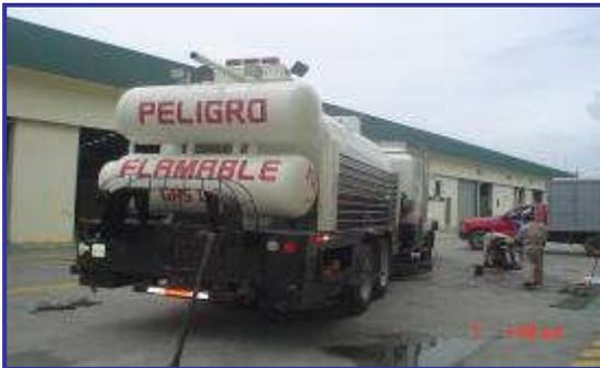
UNIDAD DE ACEITE CALIENTE PARA LEVANTAR LA **TEMPERATURA** AL AGUA DE PRUEBA 80°C Y 70KG/ CM<sup>2</sup>
