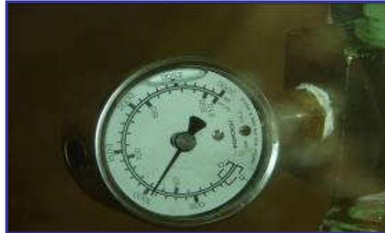
PRESIÓN DE PRUEBA ALCANZA **PMPO** A 70 KG / CM<sup>2</sup> **ACEPTABLE**
