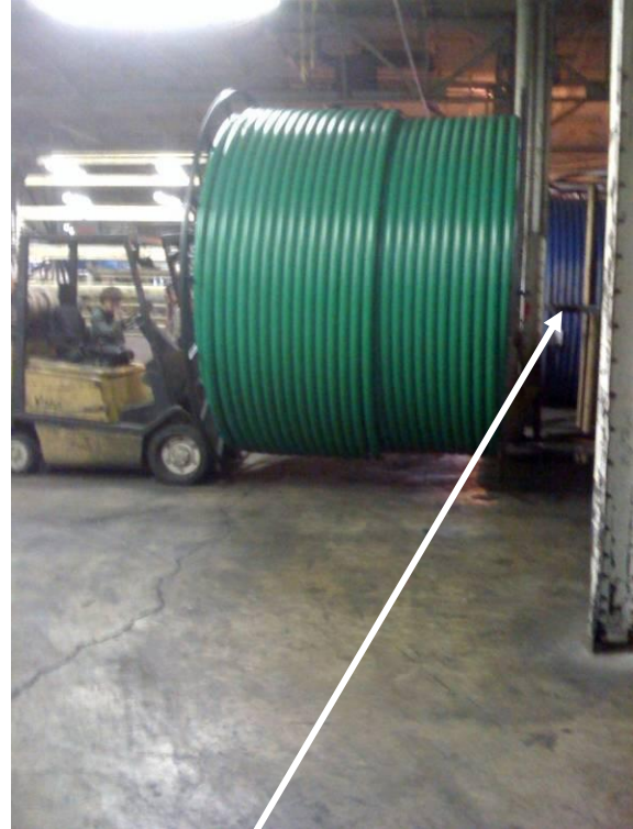
Los dientes del tenedor (o las extensiones) deben pasar al otro lado del carrete
